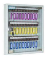
Ключница КЛ-60 предназначена для хранения 60 комплектов ключей. На задней стенке корпуса расположены отверстия для крепления. Ключница комплектуется 6 планками под навеску ключей. В дверь установлен замок типа «Cam-Lock». По желанию заказчика ключница может комплектоваться брелоками.
