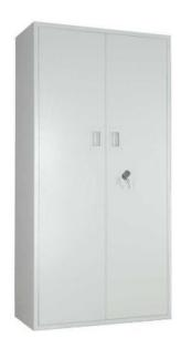
Ключница КЛ-1034 предназначена для хранения 1034 комплектов ключей. Шкаф-ключница комплектуется 94 планками под навеску ключей. В дверь установлен замок с ригельной системой запирания. По желанию заказчика ключница может комплектоваться брелоками.
