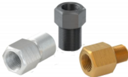
Переходники общего применения предназначены для подсоединения магистрали с рабочей средой (вода, пар, не агрессивные жидкости) к измерительному устройству в существующее посадочное гнездо, если резьба прибора отлична от резьбы места установки, а так же для соединения импульсных линий с различными резьбовыми соединениями между собой.
