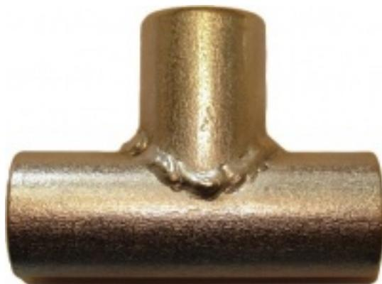
Закладная конструкция по ЗК4-1-87 предназначена для установки термопреобразователей на трубопроводе толще 76 мм или толстой металлической стенке.
